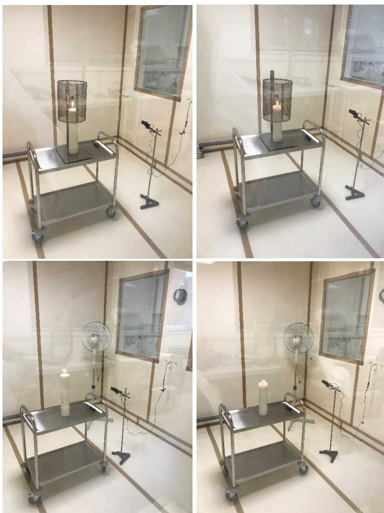
Figur 2: Forsøgsopstillingen i testkammeret med de traditionelle stearinlys i venstre kolonne og olielamperne til højre. De stabile afbrændingsforsøg ses på øverst række hvor lyset er placeret i et metaltrådnet. Nederste række viser de ustabile afbrændingsforsøg uden trådnet og med en ventilator i hjørnet.
